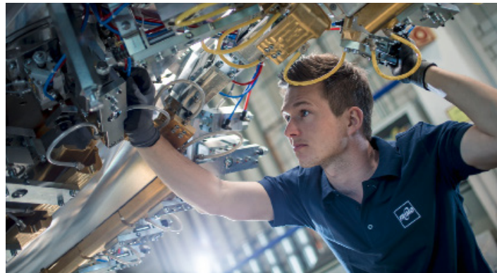
Genaueres und ressourcenschonendes Kaschieren: Erprobung eines FABL®-Presskaschier-Umbugwerkzeuges. Bild: FRIMO Freilassing GmbH
